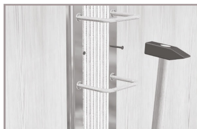
Łącznik przybić do szalunku gwoździami, przebijając perforację.
