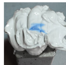
Spęczniała masa CEM 805 ACTIVE po kontakcie z wodą
